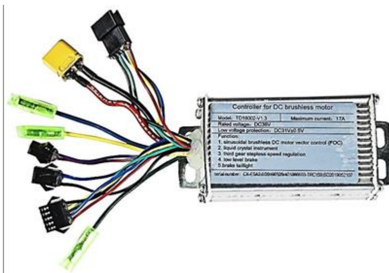
1.13 сурет - Электрондық велосипед контроллері
