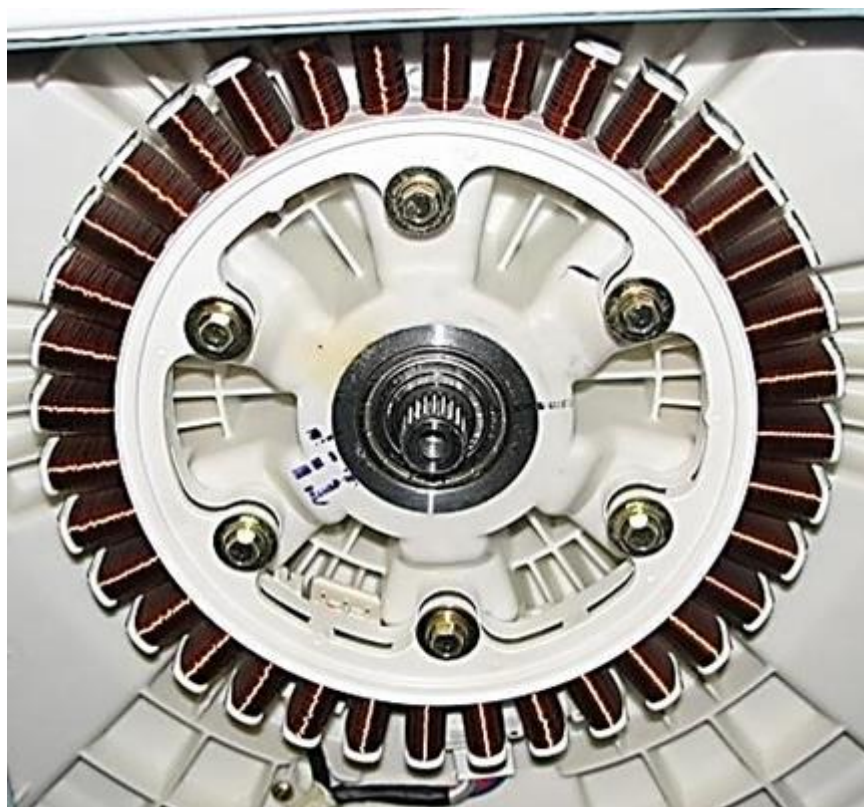
1.8 сурет - Кір жуғыш машинаның коллекторсыз қозғалтқышы LG
