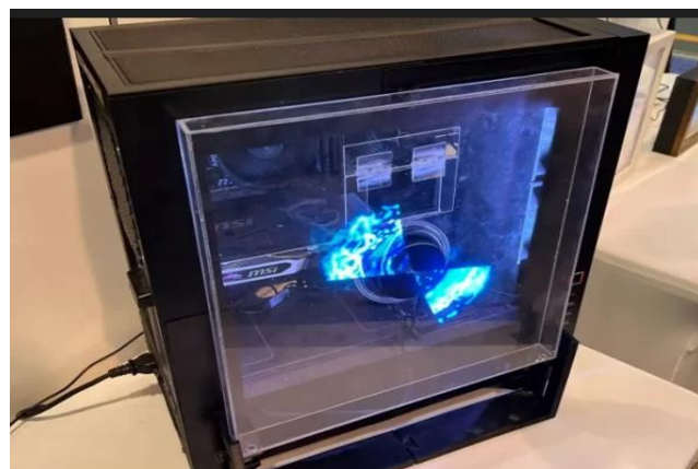
1.1 -сурет – Голографиялық кескіндердің мысалдары (1-икемді матрица, 2 – голографиялық желдеткіш)
